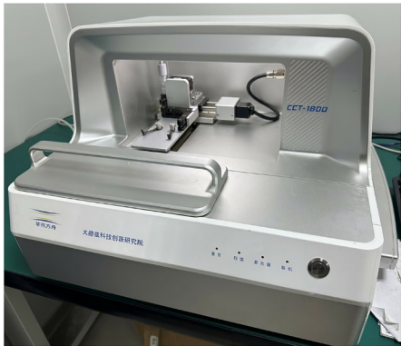
图 1 太赫兹光谱仪实物图 Fig. 1 Physical diagram of the terahertz spectrometer
